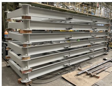
立体駐車場のパレット
