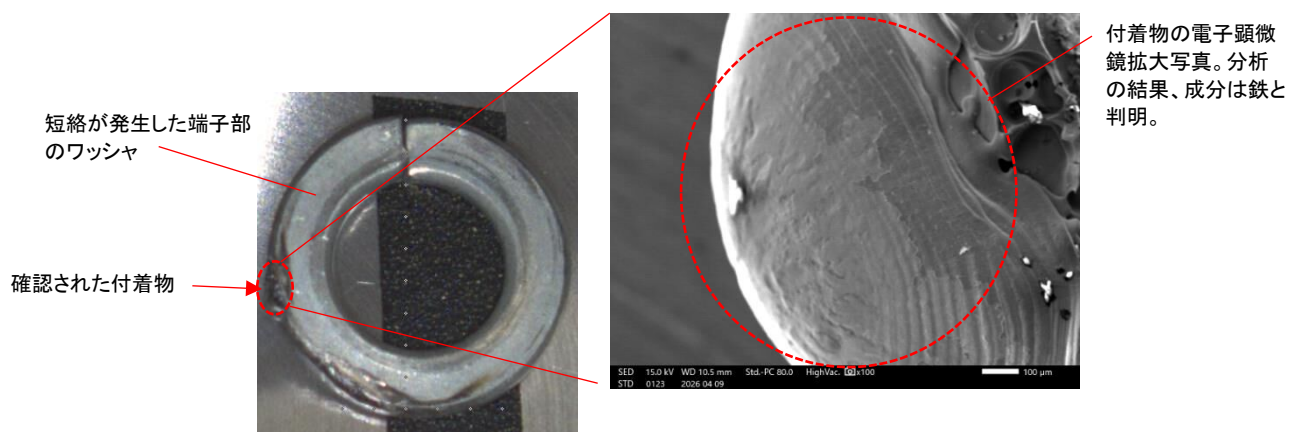
短絡が発生した端子部で検出された鉄を主成分とする付着物
