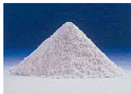
焼却灰を再利用したセメント原料 (出典：日本下水道協会ホームページ)
