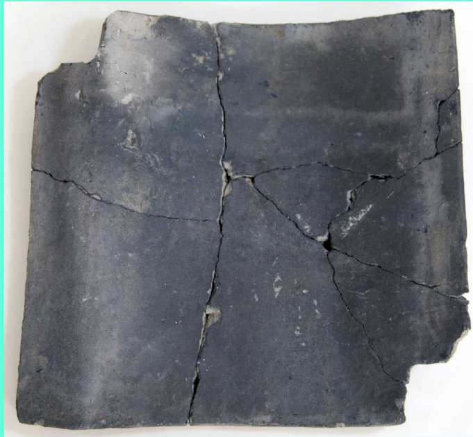
棧瓦（丸瓦と平瓦が一体化した瓦）
