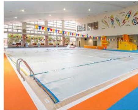
〈プールシートでの保温管理〉
