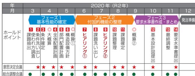
図2-4：ホールドポイントを見える化する設計工程
