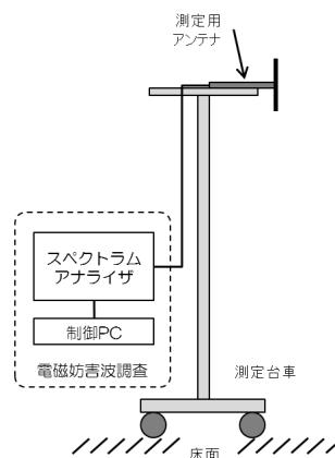
参-図 13 スペクトラムアナライザによる電波測定の機器構成例
