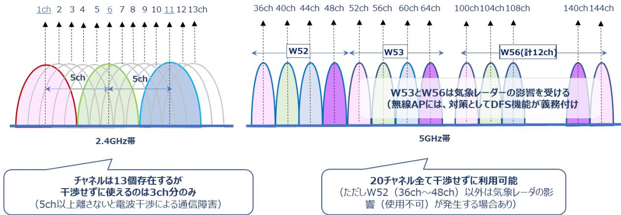
図 29 2.4GHz 帯と 5GHz 帯の利用可能な無線チャネル
