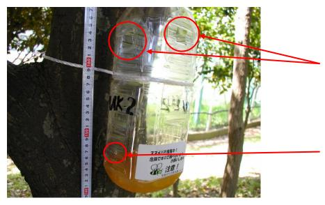
上側の切り込みは外側に折り曲 げ庇とし、雨等の侵入を防ぎ、下 側の切り込みは内側に折り曲げ、 侵入したハチが脱出しにくくす る。
