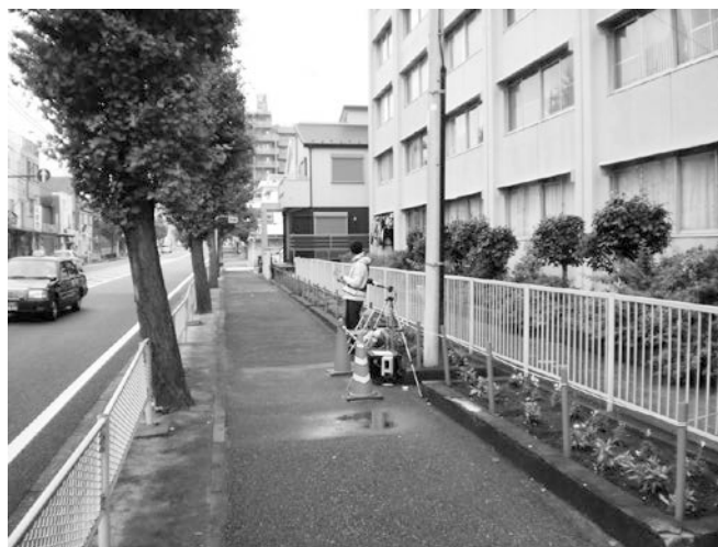
道路騒音・振動調査
