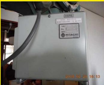
高圧発生器に、高濃度PCBを使用したコンデンサーが
