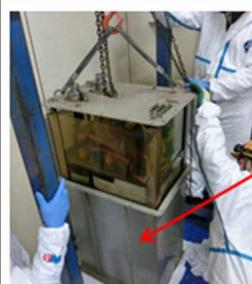
装置内は「絶縁油」で満たされている。この絶縁油に浸る内蔵の高濃度PCB使用コンデンサーの影響により、当該絶縁油にPCBが含有している可能性がある。
