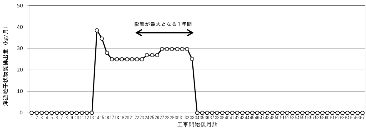
図 1-1-20(3/3) 建設機械の稼働による浮遊粒子状物質排出量
