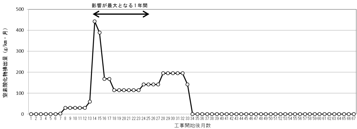
図 1-1-22 (2/3) 資材運搬車両等の走行による窒素酸化物排出量 (大矢部)
