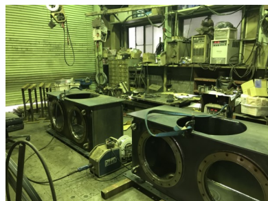
ダクト製缶中
