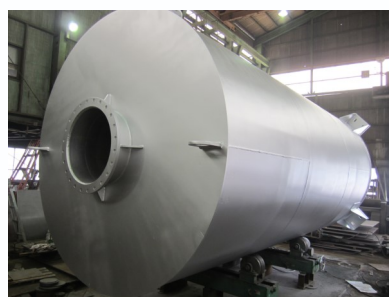
非常発電機用排気消音器
