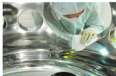
施工例（大型超高真空容器）
