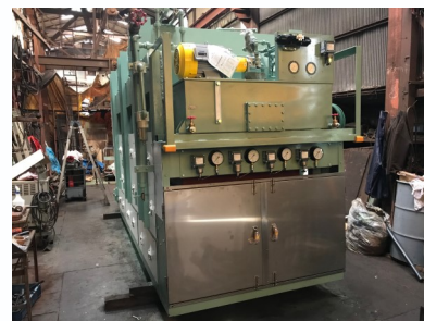
フラットベッド式ろ過機の オーバーホール事例
