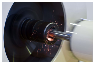
筒形状の内面を研削する
