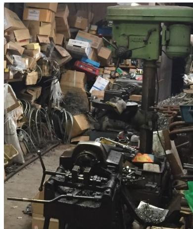
旋盤・タッパーボール盤・ネジ切り機
