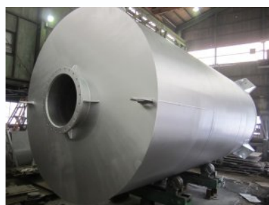
非常発電機用排気消音器
