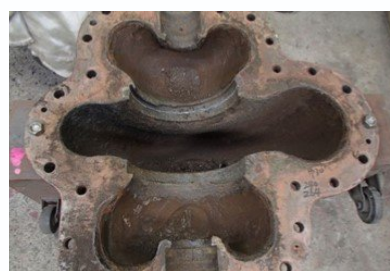
FC製ポンプケーシング 補修前
