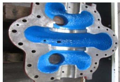
FC製ポンプケーシング 補修後
