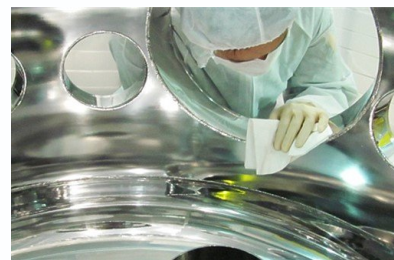
施工例（大型超高真空容器）
