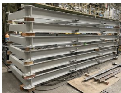
立体駐車場のパレット
