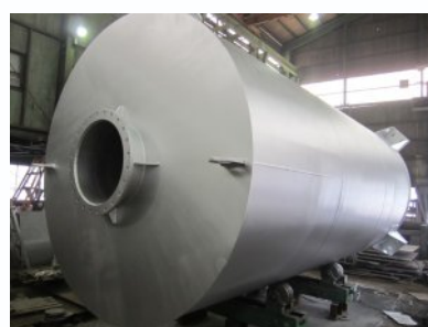
非常発電機用排気消音器
