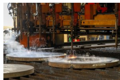
最大厚500mm対応 NCガス溶断機
