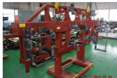
解析治具 (プレスにてパネルを成形した後の精度確認)
