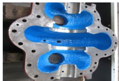
FC製ポンプケーシング 補修後
