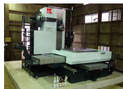
CNC横中ぐり盤 \Phi 110 \times 2000 \times 1500 (クラキ)
