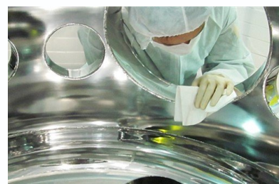
施工例（大型超高真空容器）
