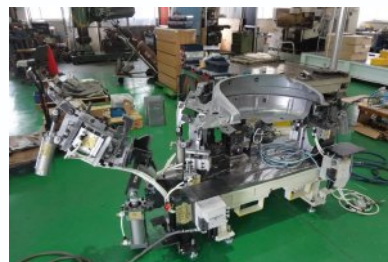
組付け治具 (数パーツを1部品にする装置)
