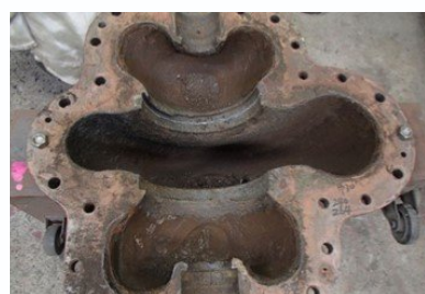
FC製ポンプケーシング 補修前
