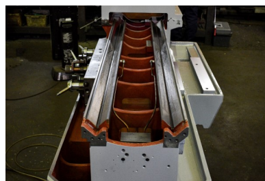
Z軸スライド(2ダブルV字型)
