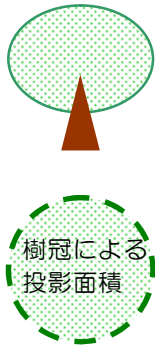
【上から見た図】 樹冠により被覆される投影面積を緑地面積として換算
