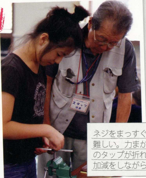
2 ネジをまっすぐ立てて挟むのが難しい。力まかせにやると道具のタップが折れてしまうので、加減をしながら慎重に。
