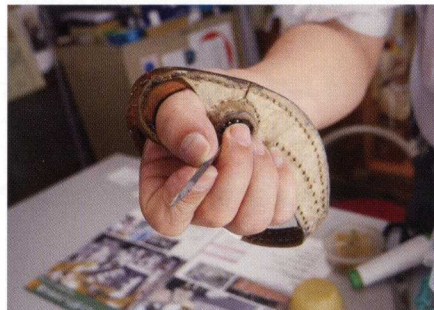
手縫いの針とあて具(パーム) ミシンで縫えないところは手縫いするそうです。厚い帆布を太い針で縫うには力が必要になります。
