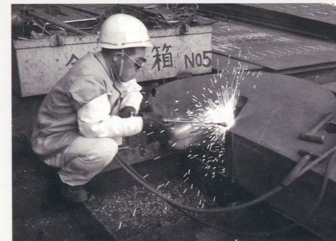
切断器でガウジング(表面を整える)している様子
