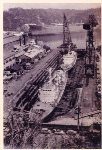
↑船を効率よく修理するため2隻同時に入渠している様子
