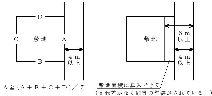
第2号の「2以上の幅員4m以上の道路等（その和は9m以上）」とは、4m以上の道路等（法第42条に規定する道路の最小幅員）と5.4m（3間道路）との和を想定している。
