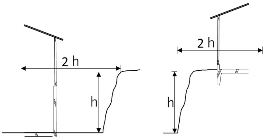
なお、擁壁の高さが2mを超える場合は、法第88条第4項に規定される許可を受けたものを除き法第88条第1項の規定に基づき確認を受ける必要がある。
