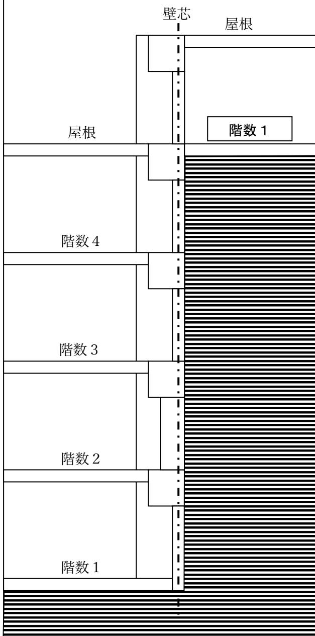
壁芯のずれにより床面積算定部分の重なりが生じる場合
