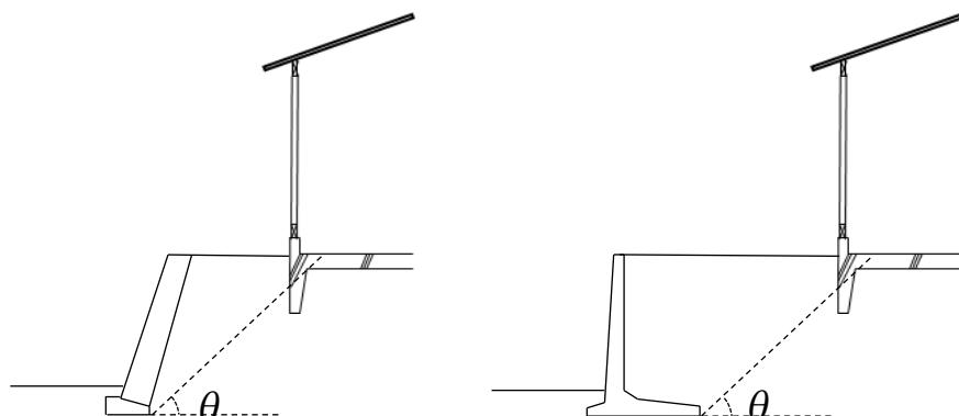
第3号の崖の下に建築する場合は主要構造部を鉄筋コンクリート造とするか、流土止め又は基礎を立ち上げる等、崖崩れによる被害を防止する施設を設けなければならない。
