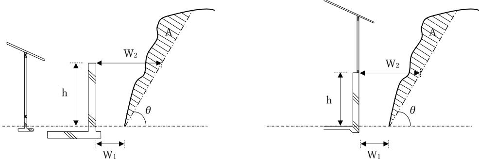
第4号の崖の下に建築する場合は、第3号の規定のほか、土砂災害特別警戒区域内における居室を有する建築物に適用される令第80条の3の規定に適合する場合に、第1項の規定が適用除外となる規定である。(一般社団法人日本建築防災協会「土砂災害特別警戒区域内の建築物に係る構造設計・計算マニュアル」参照のこと)
