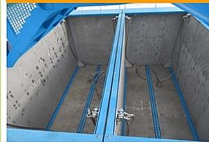
容量15m<sup>3</sup>のコンテナを2個搭載。回収したゴミを陸揚げする際には、コンテナごと吊り上げ、底板が観音開きになりゴミを陸上回収します。
