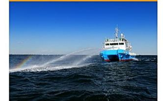
船首に備えられた2機の放水銃で、海面上の油膜をかく押し気化させます。揮発性の高い油に効果があります。
