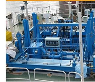
油回収器は、「油分濃縮型油回収装置」を装備しています。
