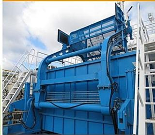
船体中央部に備えられた、大きな金属製のカゴがスキッパーです。双胴間にカゴを降ろし、海上の浮遊ゴミをすくい取ります。デッキ上と操舵室の両方から操作できます。
