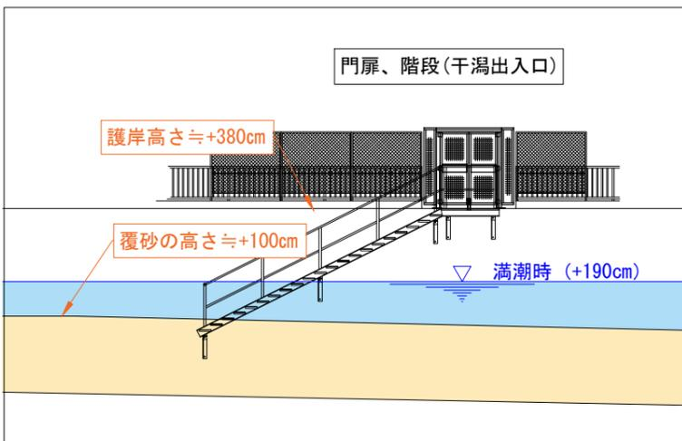
断面図(潜堤部分)
