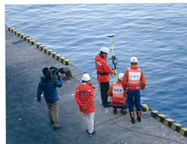
2. 着岸可否判断のための 岸壁調査
