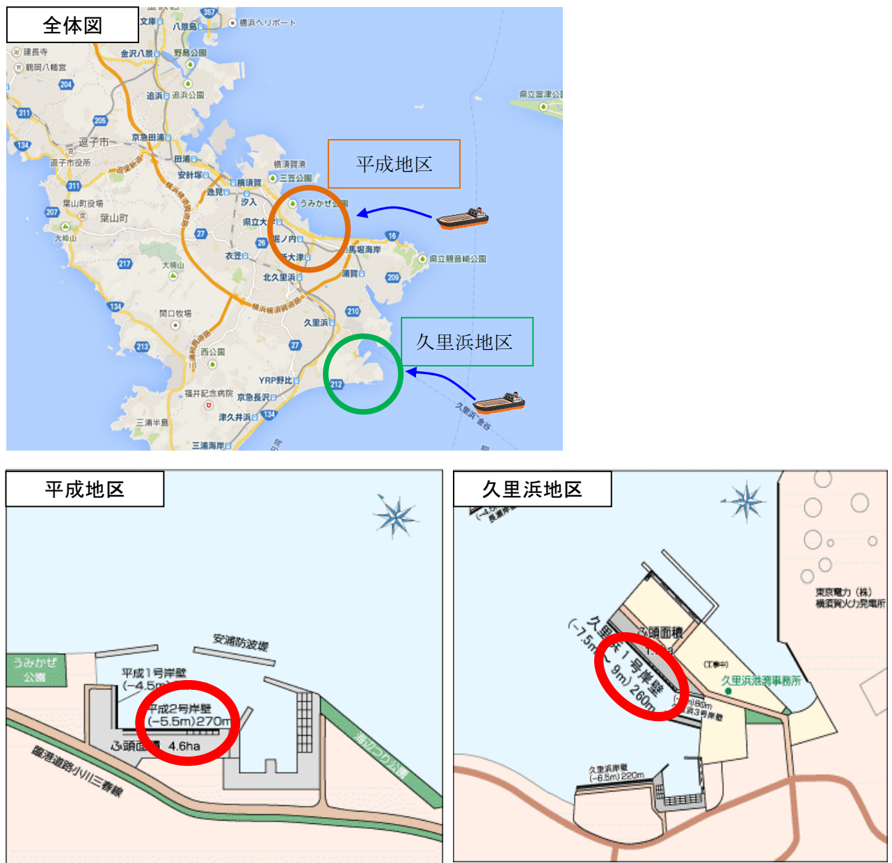
平成2号岸壁【耐震部：延長90m、水深-5.5m】
