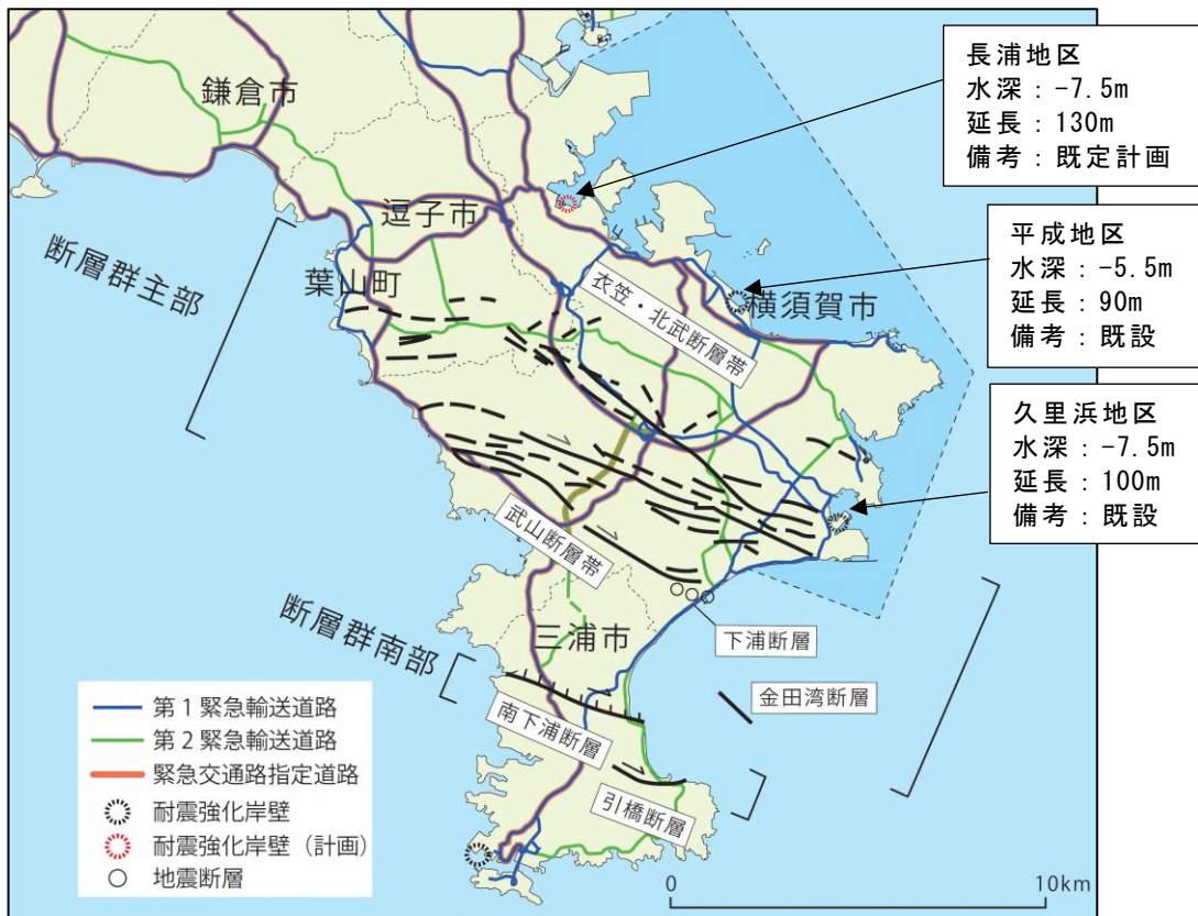
図 5-3-1 三浦半島断層群の活断層位置と緊急輸送道路・耐震強化岸壁の位置
