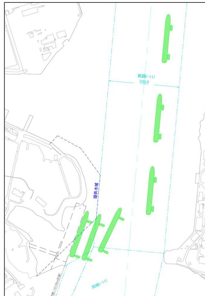
※出入港時のいずれも「港湾の施設の技術上の指針・同解説」に記載してある「安全な回頭に支障を及ぼさない広さ2L」を確保している。
