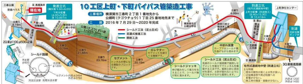
上町ポンプ場と下町浄化センターをつなぐバイパス管築造工事の断面図
