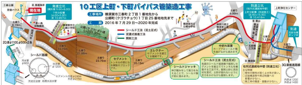
事例：上町ポンプ場と下町浄化センターをつなぐバイパス管※26築造工事（2021年完成）
