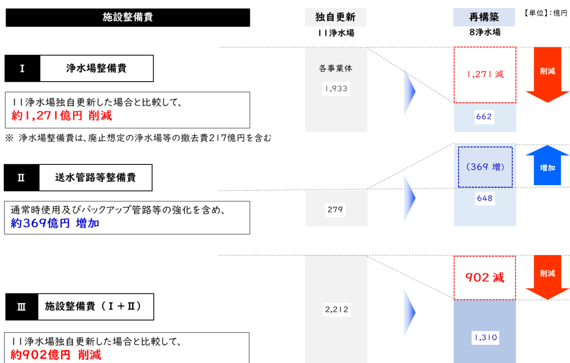
【図-15：施設整備費用の削減効果（「独自更新」と「再構築」を比較した場合）】
