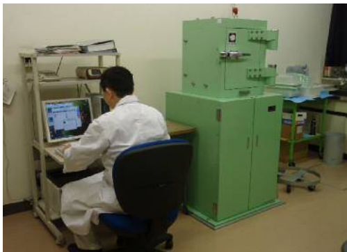
ゲルマニウム半導体検出器 ( 放射性物質の検査 )
