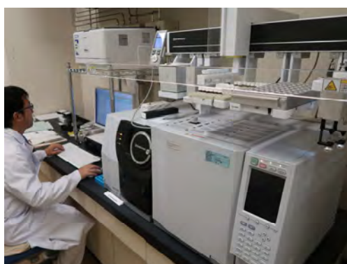
ガスクロマトグラフ質量分析装置 (消毒副生成物、農薬等の検査)
