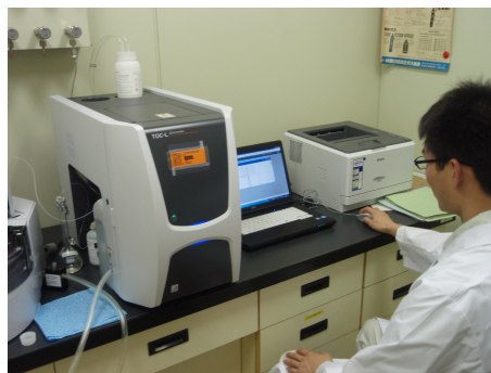
全有機炭素測定装置 （有機物の検査）
