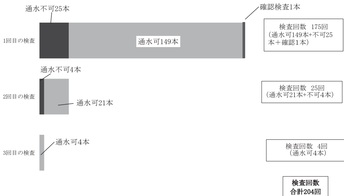
図2-2 新設配水管水質検査回数の内訳
