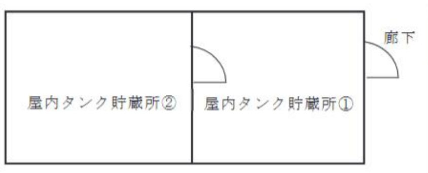
第7-2図 一方のタンク専用室を経なければならない例
