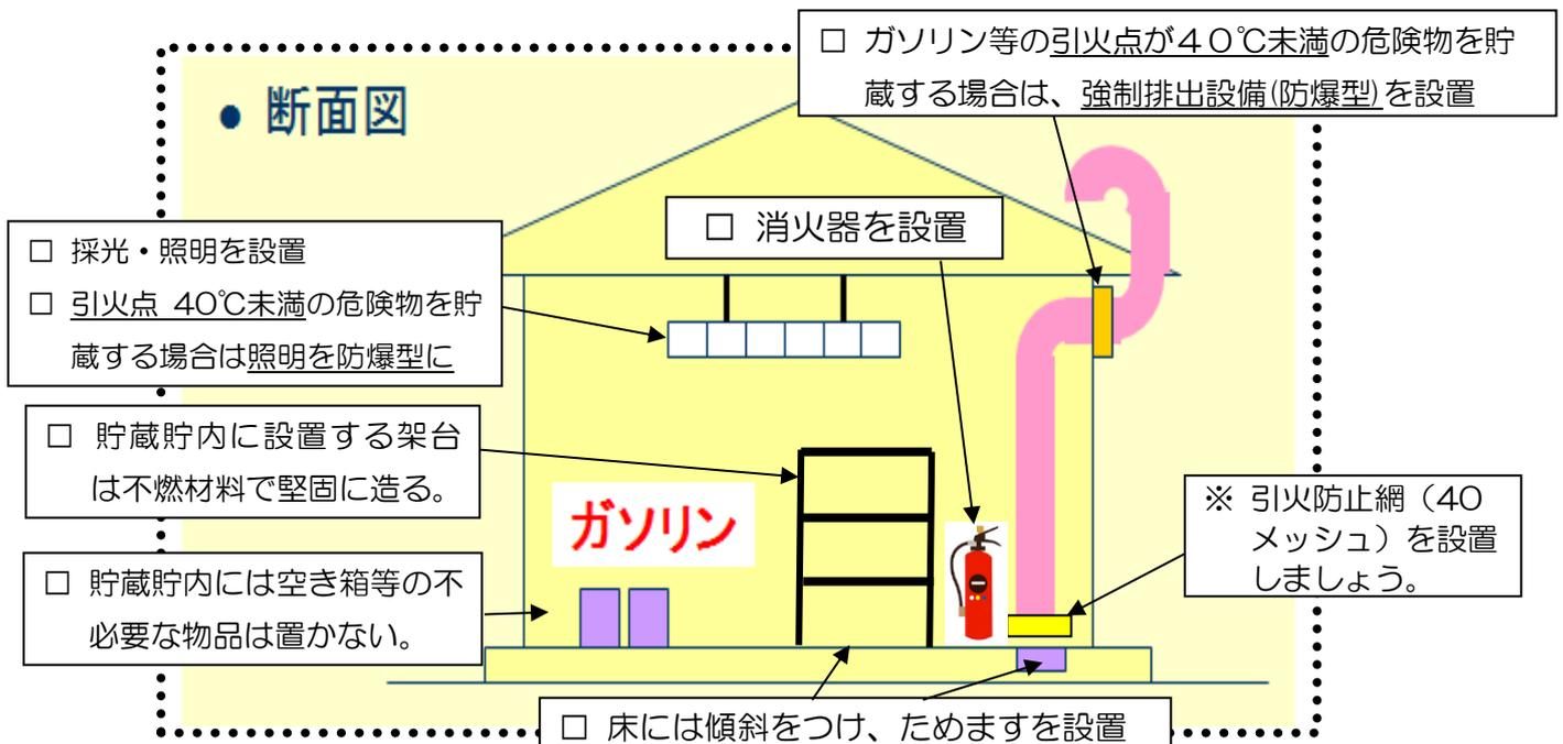
※ 灯油や軽油などの貯蔵する危険物が引火点40℃以上の危険物であり、引火点未満の状態では、電気設備を防爆型にする必要はなく、換気設備も自然換気で構いません。
