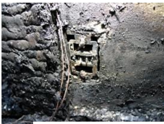
トラッキング現象により焼損したコンセントとプラグの差し刃
