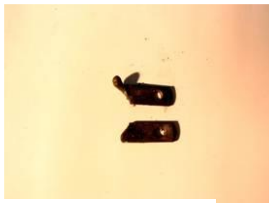
トラッキング現象により焼損したコンセントとプラグの差し刃
