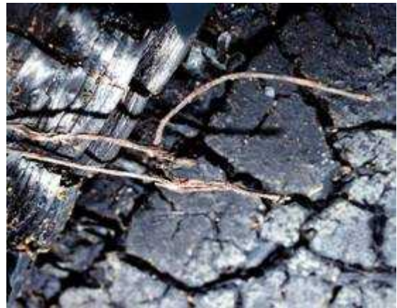
より合わせしたコードが発熱し出火
