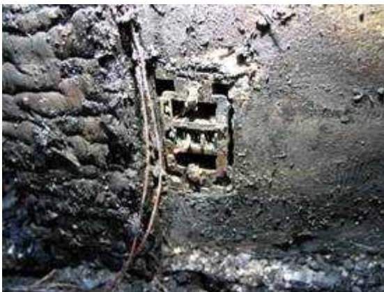
トラッキング現象により焼損したコンセントとプラグの差し刃
