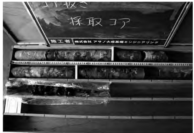
8. 高壘道コンクリート天井コア
