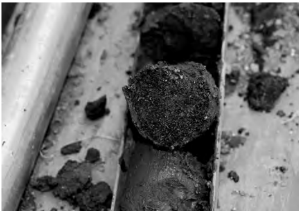
3. 現状調査・ボーリングコア中の砂層
