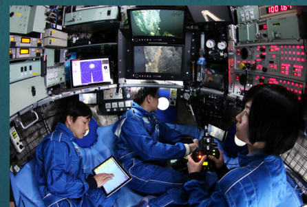
水深6500mまで潜ることができる有人潜水調査船。音波を用いることで、船体周辺の海底地形や自船位置の確認や、支援母船「よこすか」との水中通話が可能。また、船外のカメラで撮影した画像を高速度音響通信で「よこすか」に伝送できるため、船上にいながら海中の様子を知ることができる。
