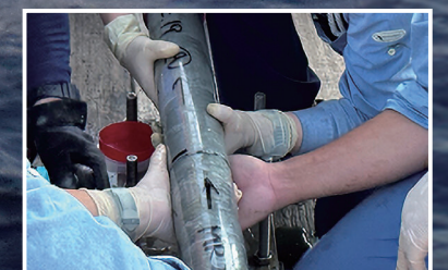
ピストンコアラで採取された海底堆積物
