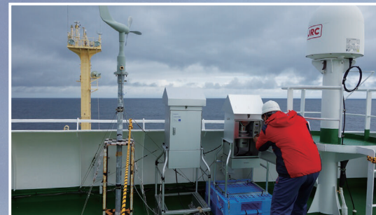
エアサンプラーによるエアロゾルの捕集
