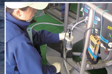
採水器からサンプル瓶への採水作業
