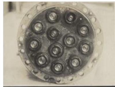
特呂二号原動機 (局地戦闘機「秋水」)搭載の噴射器 写真 個人蔵
