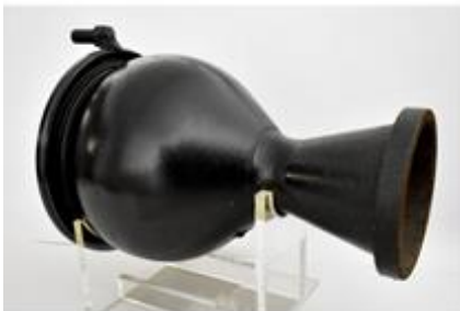
特呂二号原動機 (局地戦闘機「秋水」)搭載の燃燒室 大和ミュージアム蔵
