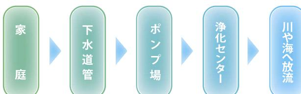
私たちが使って汚れた水(=汚水)は、道路に埋められている下水道管(污水管)に流れ込み、ポンプ場を通って浄化センターへ運ばれ、きれいな水に再生されます。また、雨水は道路の側溝や下水道管(雨水管)を通って、川や海へ放流されます。
