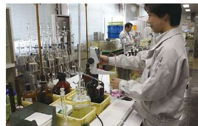
水質試験室 下水や汚泥の分析などを行います。
